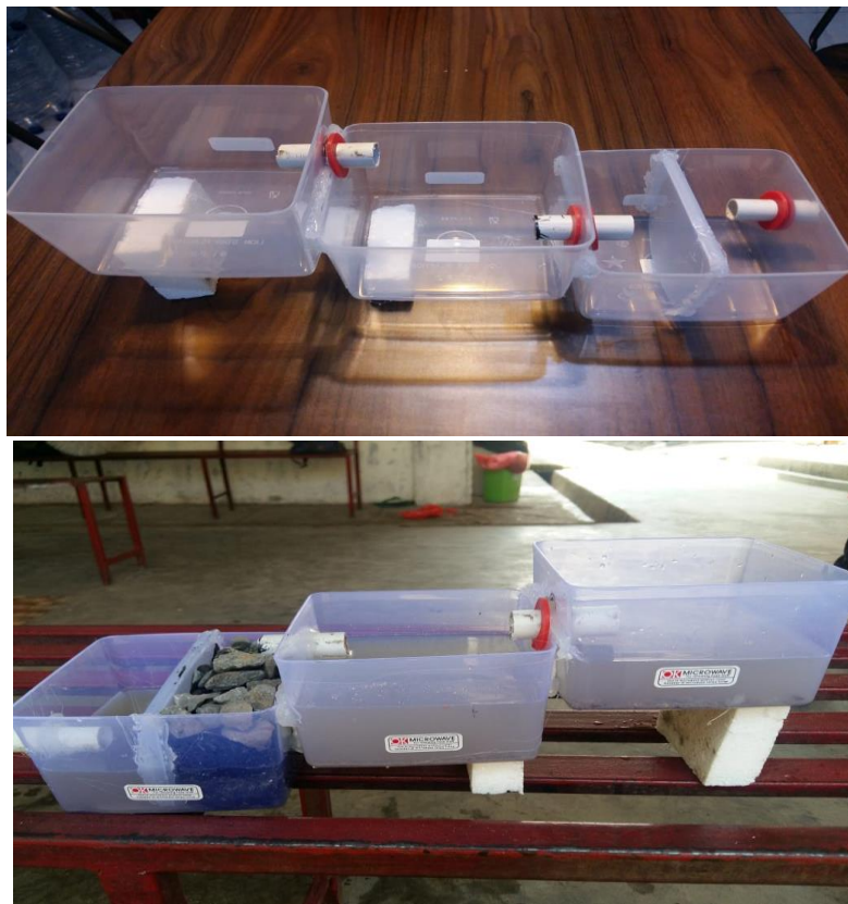
Gambar 5. Model Instalasi Pengelolaan Air Limbah (IPAL)
