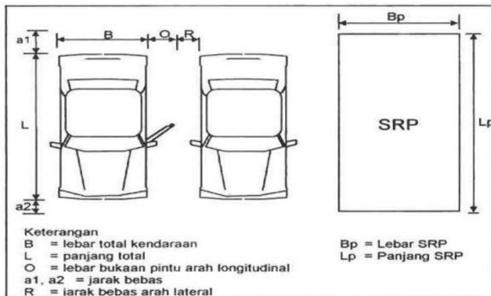
Gambar 47 Ilustrasi SRP Untuk Mobil Penumpang (dalam cm)
