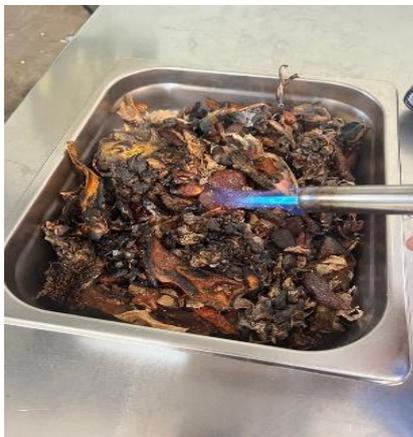
Gambar 2.4 Proses pembakaran kulit buah kering menggunakan *gas torch*
