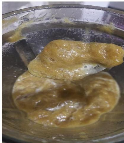
Gambar 1.13 Hasil pulp kertas yang siap untuk dicetak
