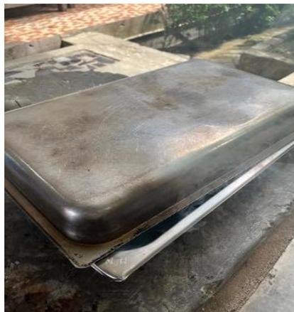
Gambar 2.6 Proses pemerataan pembakaran dengan cara menutup alat
