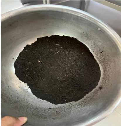
Gambar 2.9 Bubuk arang kulit buah halus yang siap untuk digunakan
