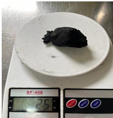
Gambar 2.12 Proses penimbangan adonan briket arang sebelum dicetak
