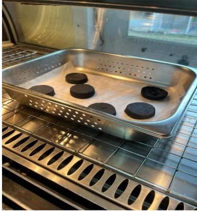
Gambar 2.16 proses pengeringan briket arang menggunakan food heater selama satu hari (Disesuaikan dengan bentuk dan ukuran briket)
