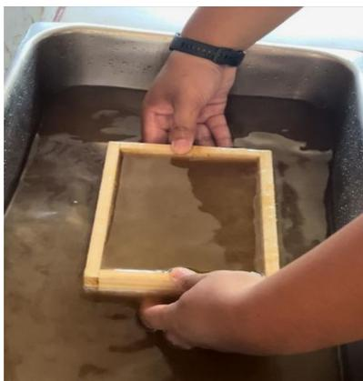
Gambar 1.16 Proses pencetakan kertas menggunakan cetakan khusus kertas daur ulang
