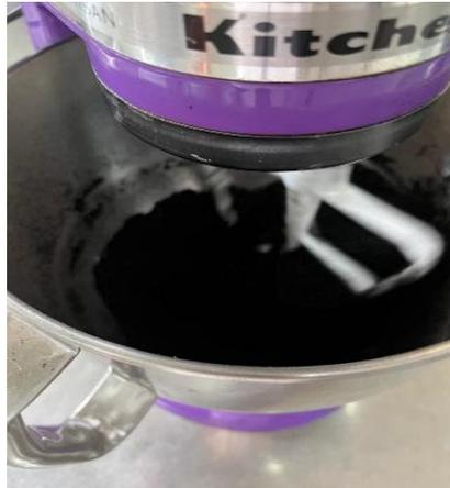
Gambar 2.11 Proses pencampuran bubuk arang buah dengan lem tapioka
