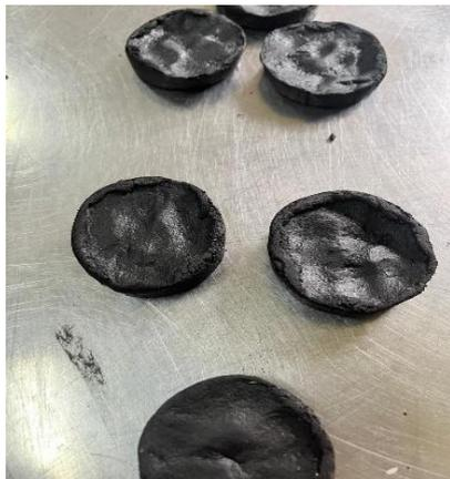
Gambar 2.14 Adonan briket arang kulit buah yang telah dicetak
